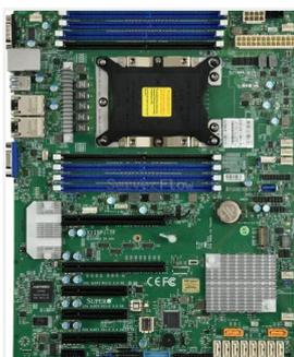
Материнская плата Supermicro X11SPI-TF (ATX, LGA3647, 8 DIMM)
